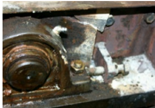
plaatmateriaal in de aandrijving band
