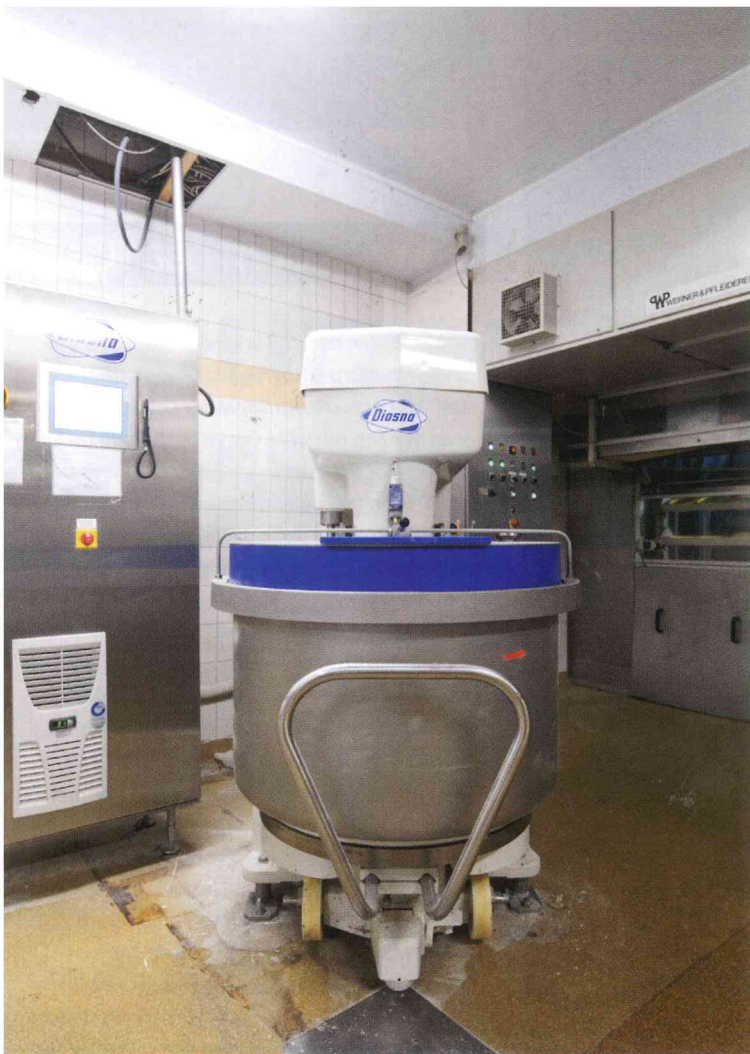
De nieuwe deegkneder is uitgerust met een frequentieregelaar voor gelijkmatig energieverbruik.
