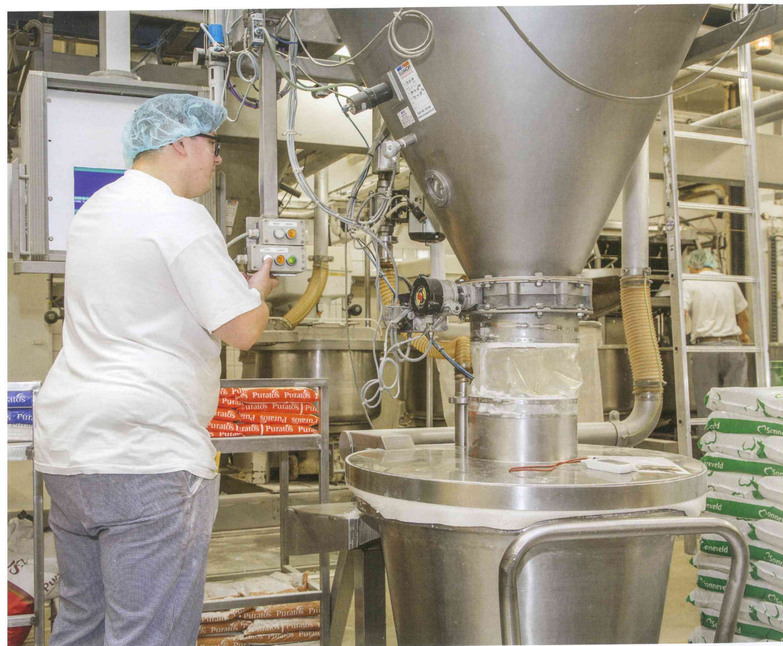
Slabben zorgen voor een optimale afzuiging van meelstof.
